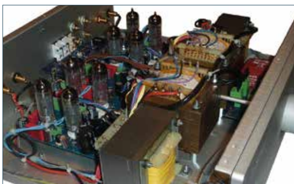
Les entrailles de l'amplificateur Solen CV 40 révèlent l'utilisation de tubes EL84.
