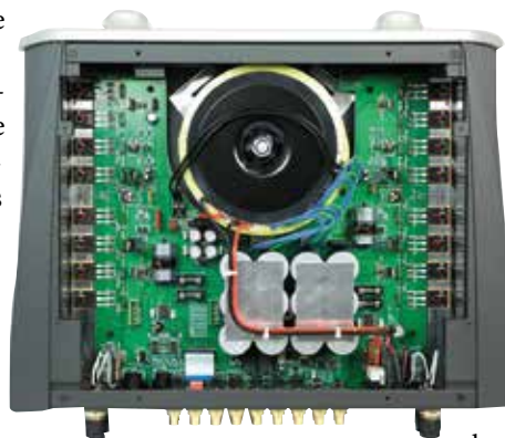
L'amplificateur Atoll IN 400 utilise des transistors Mosfet.
